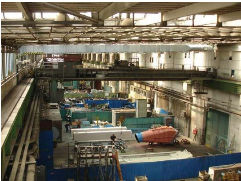
Obr. 6 - Volná lakovací plocha výrobní haly obsluhovaná manipulačně mostovými jeřáby jezdícími pod distribučním potrubím přívodního čerstvého vzduchu se stropními tryskami (stříbrné potrubí nahoře se stropními tryskami) a kolejovým vozem jezdícím po kolejkách určených pro zavážení do původní zrušené uzavřené lakovací kabiny
