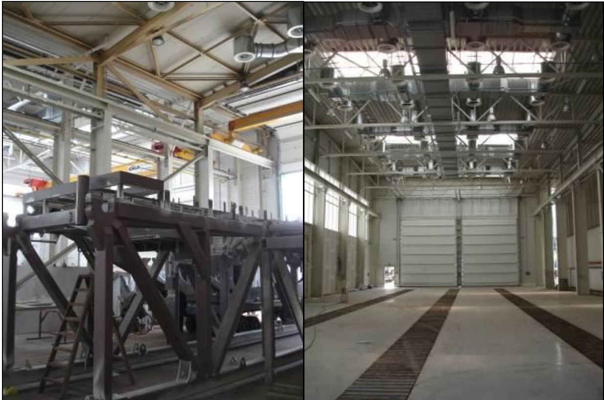
Realizace lakovny velkorozměrových dílců se sekční ventilací na volné ploše výrobní haly s typickými výrobky.
